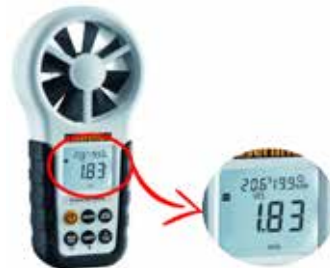
تصویر ۷. یک واحد از آخرین رقمی که ابزار اندازه‌گیری دیجیتال نشان می‌دهد، برابر دقت آن است
